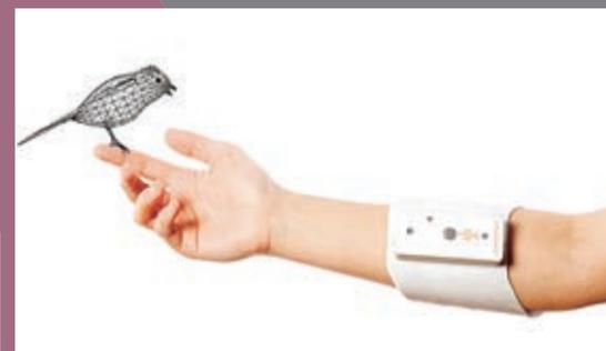
2016年、一般向けに販売された触感型ゲームローラー「Unlimited Hand」(上・PC対応)と「FirstVR」(左・スマートフォン対応)。いずれもBodySharing技術によって手の動きやジェスチャーをVRコンテンツやロボット操作に反映させるもの。まずはエンターテインメント分野から、技術の普及を目指している
