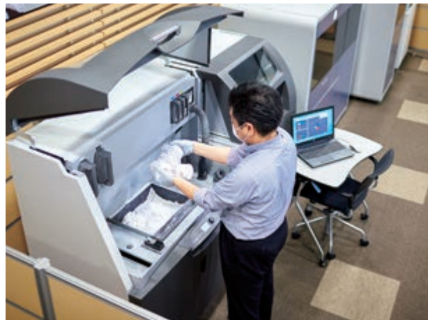
キヤノンMJグループが取り扱う3D SYSTEMS社の3Dプリンター。高い精度と強度を持った造形物をスピーディーかつ低コストで作成することができる。石膏を積層して造形するタイプは、石膏という素材の特性から医療の世界では骨のモデル出力に活用されている
