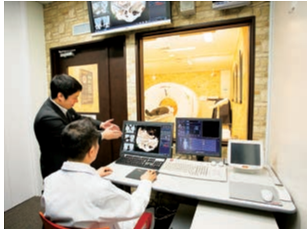
2014年にキヤノンMJグループに新たに加わったAZE社の3D医用画像解析ワークステーション。CTやMRIで撮影された人体の断層画像を独自技術で解析し、3Dプリンターで出力可能な高解像度の3Dモデルを作り出す
