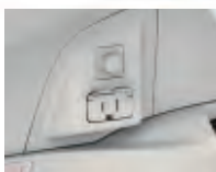
トヨタの「プリウスPHV」はオプションで家庭用と同じAC100Vのコンセントが設置できる
