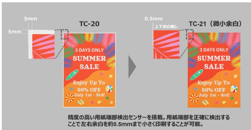
「微小余白印刷機能」の仕組み
