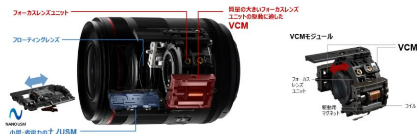
「VCM（ボイスコイルモーター）」と「ナノ USM（超音波モーター）」を組み合わせた「電子式フローティングフォーカス制御」により優れたフォーカスを実現 （画像は「RF35mm F1.4 L VCM」のイメージ）
