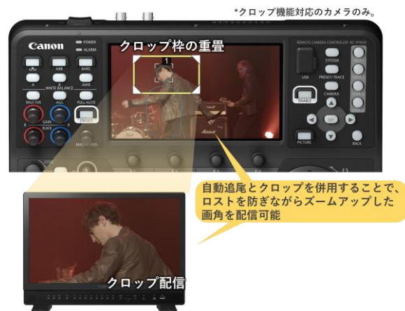
カメラクロップ枠と自動追尾のシルエット表示を重畳することで容易な構図調整が可能
